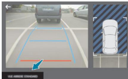
Per attivare la telecamera, situata sul portellone posteriore, inserire la retromarcia e non superare la velocità di 10 km/h.
