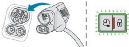
► Secondo la versione, rimuovere il rivestimento di protezione dalla sezione inferiore.
