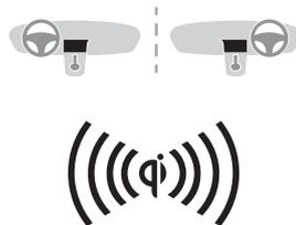
Consente la ricarica senza fili di dispositivi mobili, ad esempio uno smartphone, utilizzando il principio di induzione magnetica, secondo la norma Qi 1.1.
