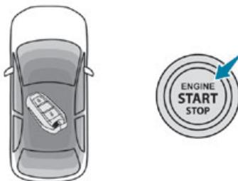
Con la chiave elettronica nell'abitacolo, premendo il pulsante "**START/STOP**" **senza premere i pedali**, è possibile inserire il contatto senza avviare il motore.
