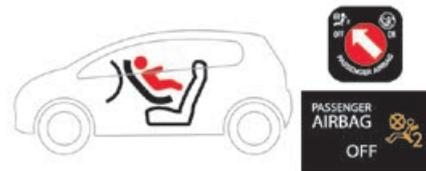
! Se sul sedile del passeggero anteriore è installato un seggiolino per bambini con schienale verso la strada, l'airbag frontale del passeggero deve essere disattivato. In caso contrario, **il bambino rischia ferite gravi o addirittura mortali in caso di attivazione dell'airbag.**
