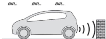
Il sistema segnala la presenza di ostacoli all'interno della zona di rilevazione dei sensori. Le informazioni di prossimità vengono fornite da un segnale acustico discontinuo, la cui frequenza aumenta con l'avvicinarsi del veicolo all'ostacolo.
