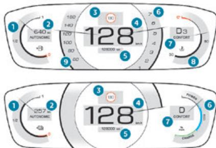
1. Indicatore del livello del carburante (benzina o Diesel)
