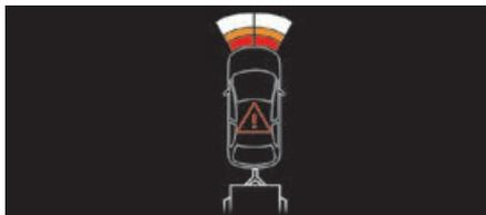
**i** L'assistenza al parcheggio posteriore verrà disattivata automaticamente se un rimorchio o un portabiciclette è agganciato a un dispositivo di traino installato secondo le raccomandazioni del Costruttore. In questo caso, il profilo di un rimorchio verrà visualizzato nella parte posteriore dell'immagine del veicolo.
